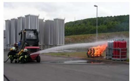
Bei einer in einem geschlossenen Raum aufgestellten Flasche, deren Ventil nicht mehr geschlossen werden kann, soll während der Kühlung mit Wasser die am Ventil austretende Flamme normalerweise nicht gelöscht werden. Wird die Flamme gelöscht, kann das Gas weiter ausströmen und eine Explosion verursachen. Die Flamme darf nur gelöscht werden wenn:
