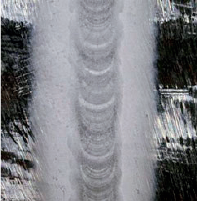
Bild 4: Mechanisierte WIG-AC-Blindraupe auf beschliffener Aluminiumoberfläche. Schutzgase: Links Argon (ISO 14175-I1), rechts VARIGON ® S (ISO 14175-Z-ArO-0,031).
