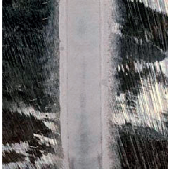
Bild 4: Mechanisierte WIG-AC-Blindraupe auf beschliffener Aluminiumoberfläche. Schutzgase: Links Argon (ISO 14175-I1), rechts VARIGON ® S (ISO 14175-Z-ArO-0,031).
